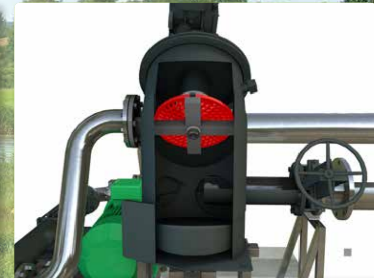
Mazerator: 1. Stufe: Störstoffabscheider
