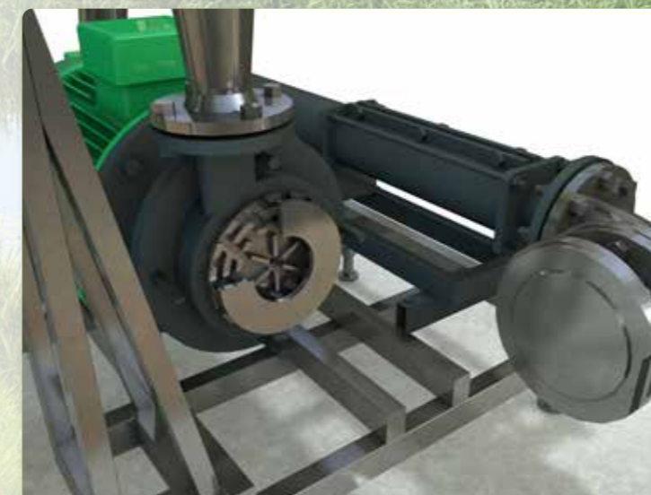
Kavitationsmodul: 2. Stufe: Zermahlen der Faserstoffe
